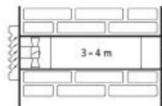
standardní vhodné řešení s modelem SILENT s vnitřní mřížkou a nejnižší tlakovou ztrátou
