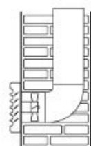
standardní vhodné řešení s modelem SILENT s vnitřní mřížkou, krátkým potrubím a přijatelnou tlakovou ztrátou
