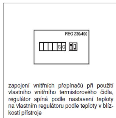
zapojení vnitřních přepínačů při použití vlastního vnitřního termistorového čidla, regulátor spiná podle nastavení teploty na vlastním regulátoru podle teploty v blízkosti přístroje
